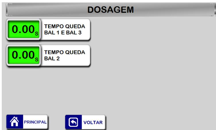
**Tempo de queda:** Será utilizado somente para sincronizar o funcionamento com a empacotadora automática.
