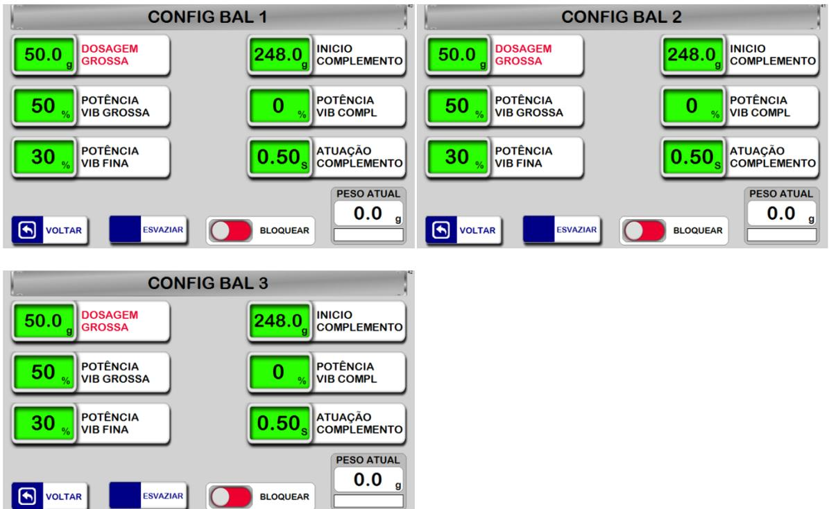
**DOSAGEM GROSSA:** Define o peso de corte da vibração grosso, ao atingir o valor programado, finalizando o processo de vibração grossa e dando início para o processo de vibração fina.
