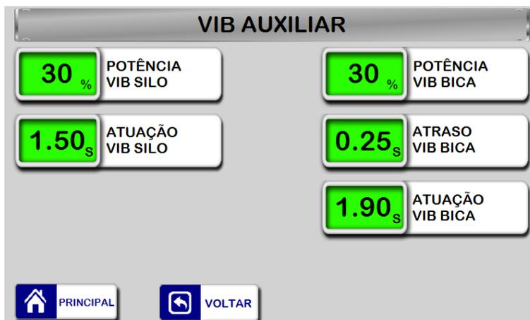
Aperte em cima da porcentagem, para selecionar a intensidade da vibração desejada no silo (**POTÊNCIA VIB SILO**), logo após aperte em cima do S, para selecionar a atuação (**É O TEMPO QUE ELA PERMANECERÁ VIBRANDO**) da bobina no silo (**ATUAÇÃO VIB SILO**).
