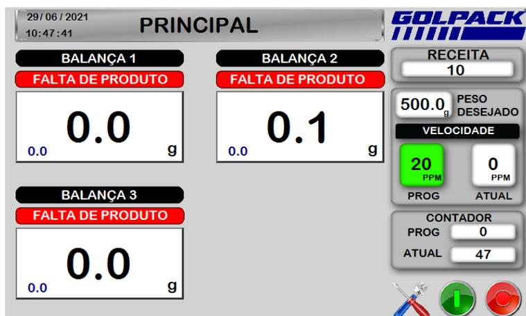
A balança já sai programado com o tempo de 1 minuto, após o termino do tempo e não ter completado o peso desejado, a balança informe a falta de produto.
