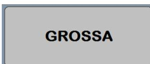
Este visor indica o status da máquina, “Grossa” indica que a máquina está em processo de Dosagem, dentro do período de dosagem grossa.
