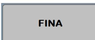
Este visor indica o status da máquina, “Fina” indica que a máquina está em processo de Dosagem, dentro do período de dosagem fina.
