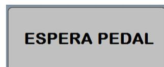
Este visor indica o status da máquina, “Espera Pedal”, significa que a máquina está em operação, aguardando acionamento do Pedal para executar a Dosagem.
