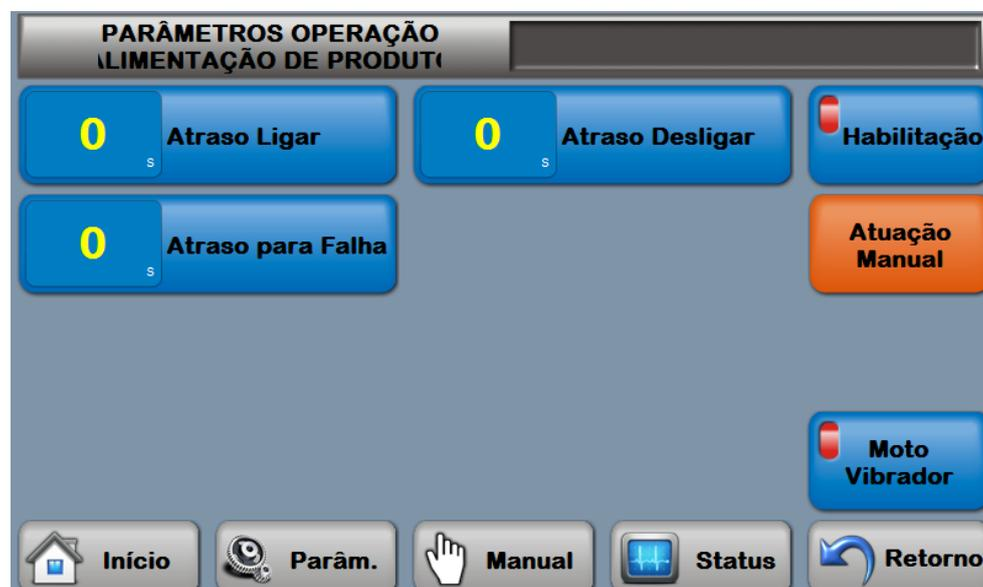
A operação **Alimentação de Produto**, tem a função de manter a balança dosadora com um fluxo constante de produto.
