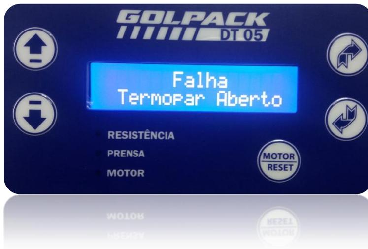
Informa falha no sensor de temperatura (termopar). Caso essa falha seja apresentada, o sistema interrompe o funcionamento do datador, e o mesmo será restabelecido após a solução do problema.
