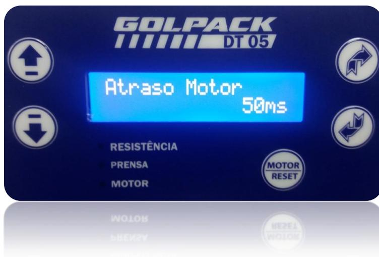
Programa o atraso para o acionamento do motor após o retorno da prensa.
