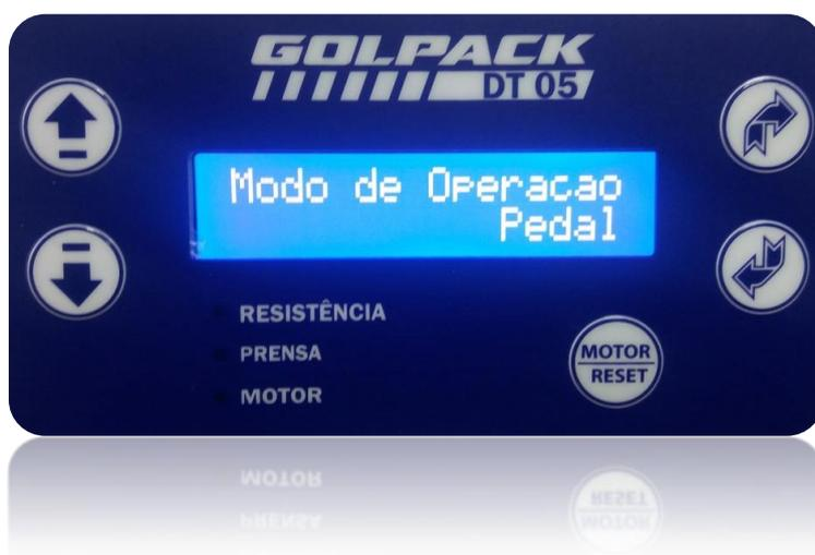
Programa o modo de operação do datador. Pressionando a seta
